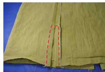
⑪ スリットの始末をする 縫代をアイロンで割り スリットを出来上がりに折り縫う
