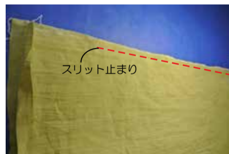
⑩ 脇を縫う 前後身頃の脇を中表に 合わせてスリット止まり まで縫う
