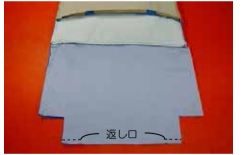
⑦ 本体裏の底を縫う 本体裏の底を中表に合わせて縫う (返し口をあけておく)。
