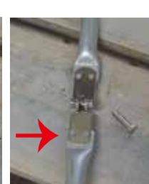
① ニュームカンについているネジをはずす (両側) ② 口布にニュームカンを通す ③ 片方の金具が通ったところ
