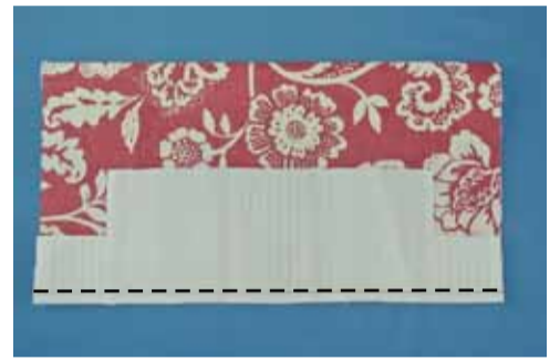
② 切替を縫う ②-1 本体表と切替を中表に合わせて縫う
