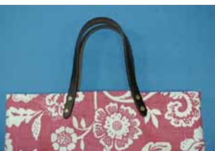
⑨ 手紐を付ける 型紙の手紐付け位置にカシメで付ける (カシメの付け方参照)
