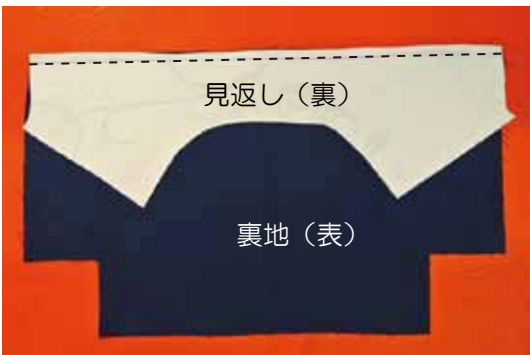
⑤ 見返しと裏地を縫う ⑤-1 見返しと裏地を中表に合わせて縫う
