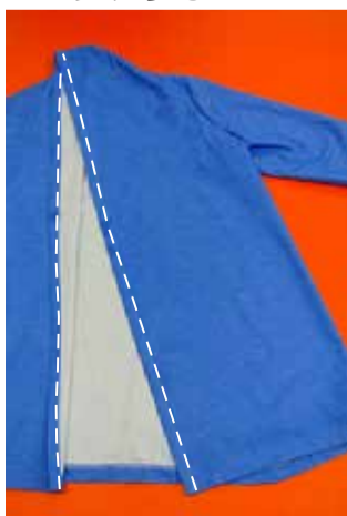
⑥ 衿周りと前端を縫う 三つ折りにして前端から衿周りを続けて縫う
