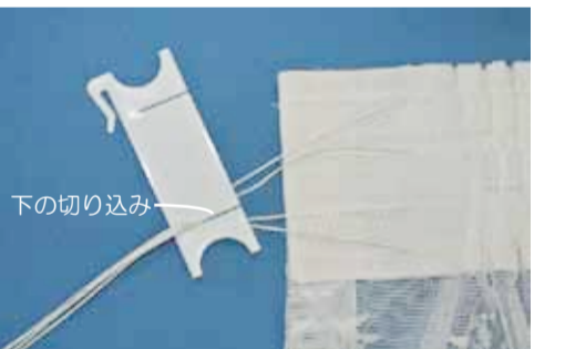
⑤ 紐を始末する ⑤-1 4本の紐をまとめてコードタイの下の切り込みに入れる
